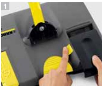
**1 Facile sostituzione della batteria.** La batteria agli ioni di litio può essere sostituita senza attrezzi.
